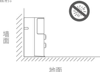
2) 在水平地面放置充电座，并连接电源。
