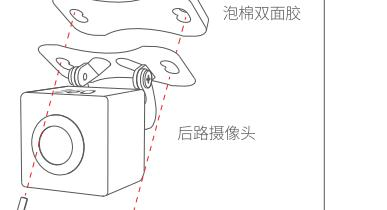
① 将数据线插头插入主机的后路摄像头接口内
