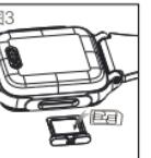
图1.手表关机，并使用取卡器将SIM卡托取出；
