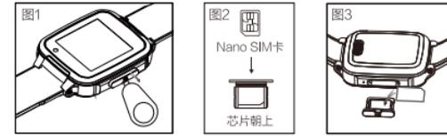
图1.手表关机，并使用取卡器将SIM卡托取出；
